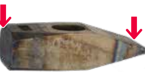
TRATAMENT TERMIC PRIN INDUCTIE PE CAPETE
