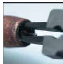
eliminarea stropilor de sudura din interiorul și exteriorul duzei
