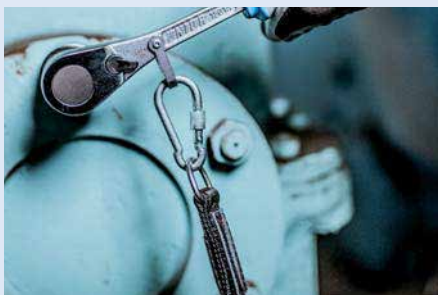
Utilizarea clichetului. Clichetul nu are buton pentru comutarea capetelor tubulare ca un clichet standard.
