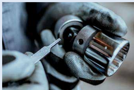
Când montați capete sau extensii, asigurați-vă că orificiul din priză și știftul de pe unitatea pătrată sunt aliniate. Utilizarea dispozitivului de îndepărtare a capetelor tubulare (articolul 1111) apasă știftul în timp ce atașează tubulura. Asigurați-vă că știftul face clic în gaură.
