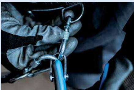
Înainte de a scoate scula din curea, deșurubați inelul de blocare de pe carabiniera.
