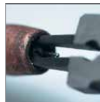
eliminarea stropilor de sudură din interiorul și exteriorul duzei
